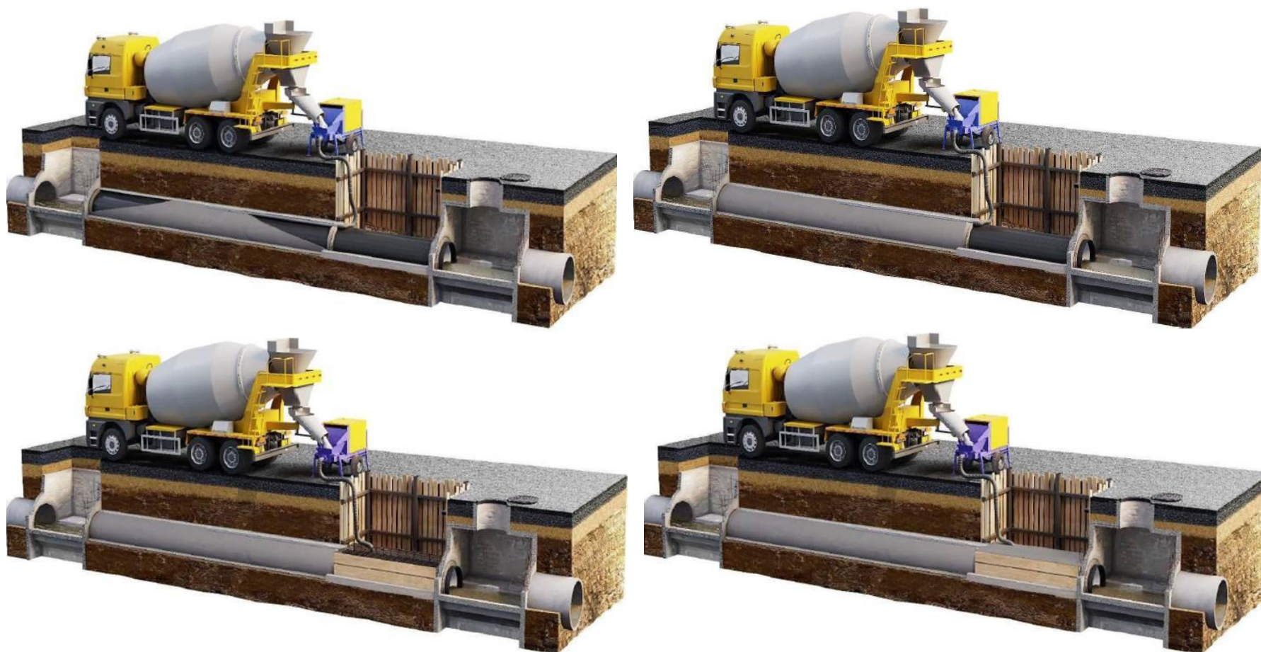
2.10-сурет - Құбыраралық кеңістікті және коллектор тоғыспасын тығындау
