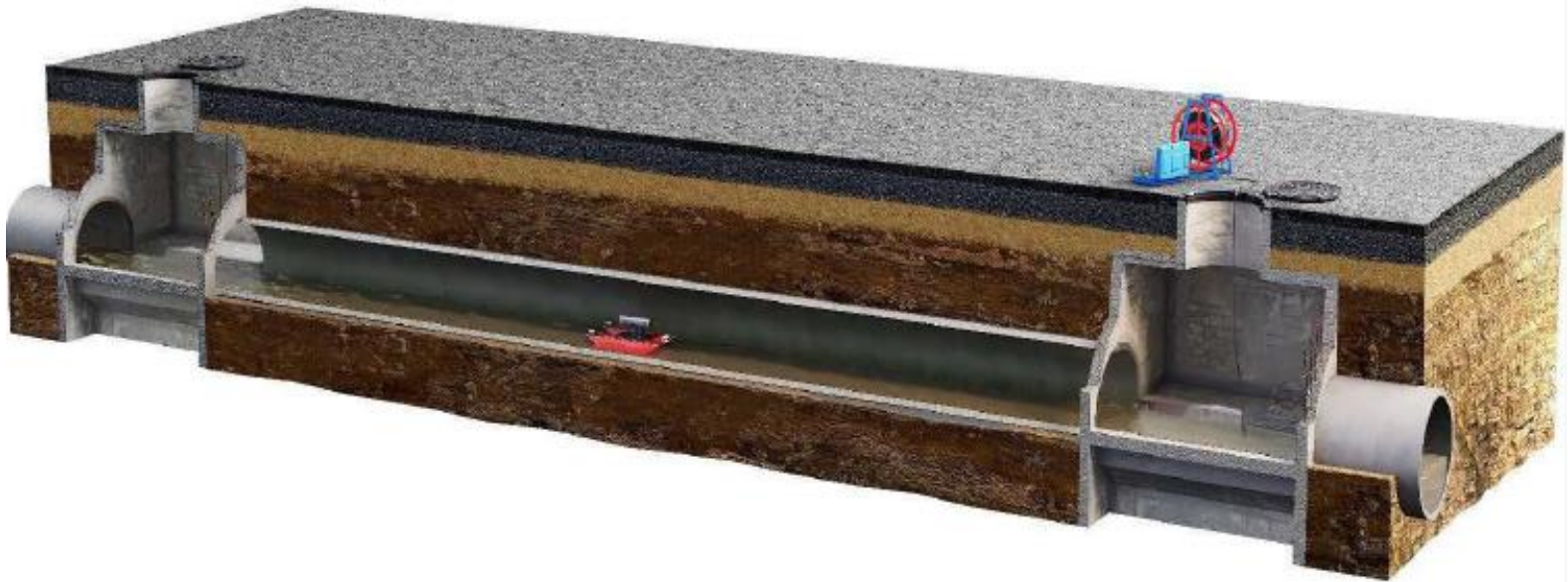
2.4-сурет – Робототехникалық жабдықпен телеинспекция
